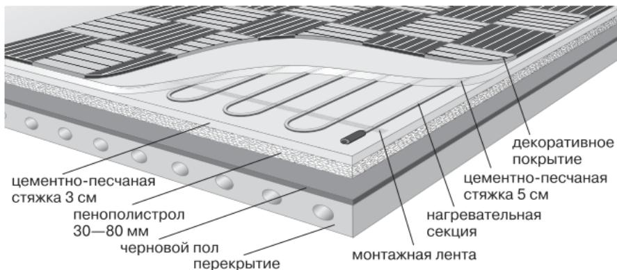
При установке комплекта теплого пола под плитку применение теплоизоляции не допускается, поскольку это может привести к растрескиванию слоя клеевого раствора толщиной 5–8 мм, покрывающего нагревательный кабель.
